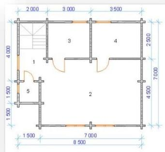
Обвязка 200x150, лаги 50x150, черный пол 25x150 пропитанная антипиреном, стропильная система профилированный брус напильный по проекту 115 x 135.
