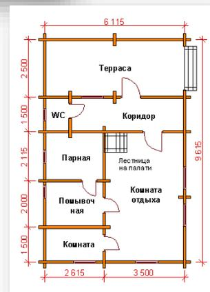
Обвязка 200x150, лаги 50x150, черный пол 25x150 пропитанная антипиреном, стропильная система профилированный брус напильный по проекту 115 x 135.
