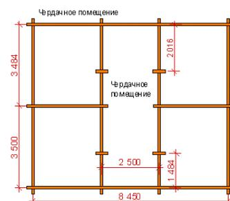
Обвязка 200х150, лаги 50х150, черный пол 25х150 пропитанная антипиреном, стропильная система профилированный брус напильный по проекту 115 х 135.
