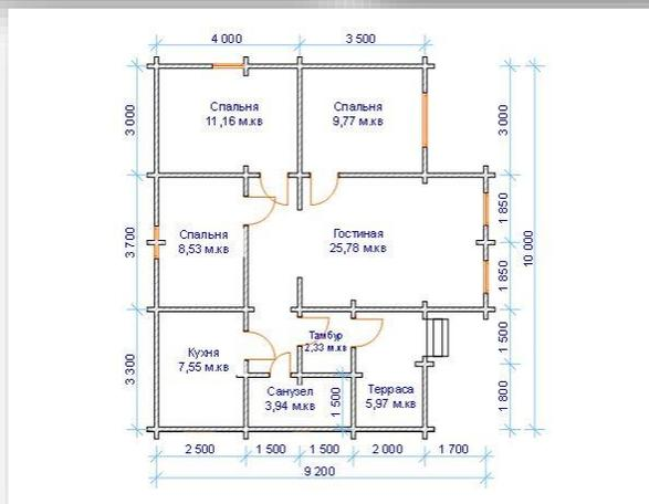
Обвязка 200x150, лаги 50x150, черный пол 25x150 пропитанная антипиреном, стропильная система профилированный брус напыленный по проекту 115 x 135.
