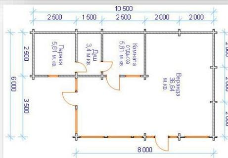
Обвязка 150х150, лаги 50х150, черный пол 25х150 пропитанная антипиреном, стропильная система профилированный брус напильный по проекту 90х135.
