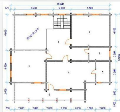
Обвязка 200x150, лаги 50x150, черный пол 25x150 пропитанная антипиреном, стропильная система профилированный брус напильный по проекту 140 x 135.
