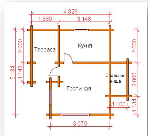
Обвязка, стеновой комплект профилированный брус 45x135 , фундамент блоки, крыша ондулин.
