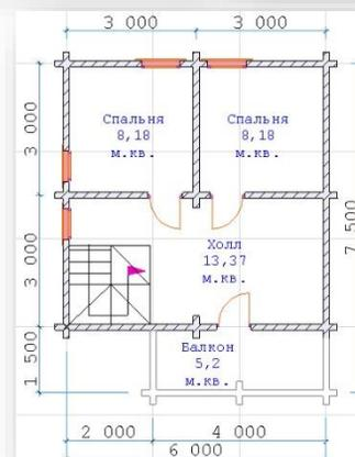
Обвязка 200x150, лаги 50x150, черный пол 25x150 пропитанная антипиреном, стропильная система профилированный брус напильный по проекту 140 x 135.
