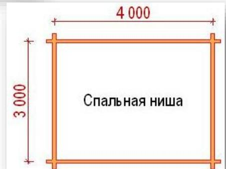
Обвязка 150x150, лаги 50x150, черный пол 25x150 пропитанная антипиреном, стропильная система профилированный брус напильный по проекту 90 x 135.
