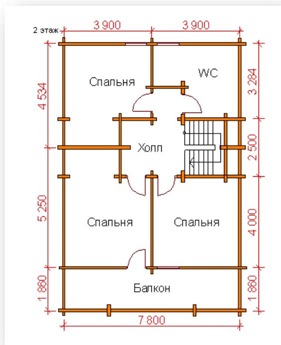
Обвязка 200х150, лаги 50х150, черный пол 25х150 пропитанная антипиреном, стропильная система профилированный брус напильный по проекту 115 х 135.
