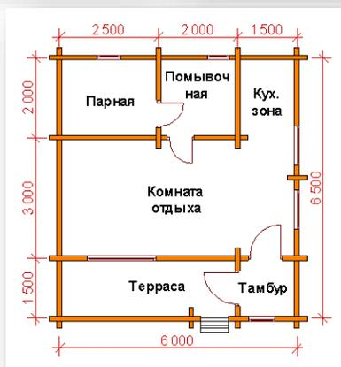
Обвязка 150x150, лаги 50x150, черный пол 25x150 пропитанная антипиреном, стропильная система профилированный брус напильный по проекту 90 x 135.
