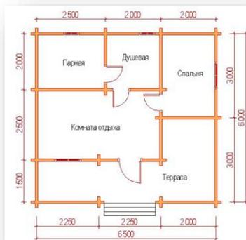
Обвязка 150x150, лаги 50x150, черный пол 25x150 пропитанная антипиреном, стропильная система профилированный брус напильный по проекту 90 x 135.
