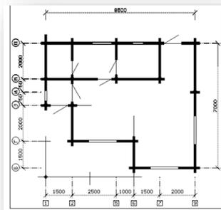
Обвязка 200x150, лаги 50x150, черный пол 25x150 пропитанная антипиреном, стропильная система профилированный брус напильный по проекту 115 x 135.
