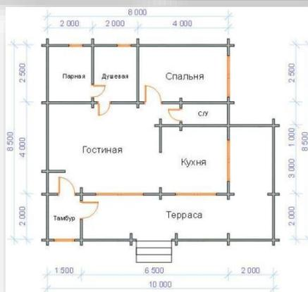
Обвязка 200х150, лаги 50х150, черный пол 25х150 пропитанная антипиреном, стропильная система профилированный брус напильный по проекту 115 х 135.
