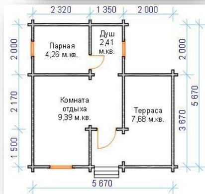
Обвязка 150х150, лаги 50х150, черный пол 25х150 пропитанная антипиреном, стропильная система профилированный брус напильный по проекту 90х135.
