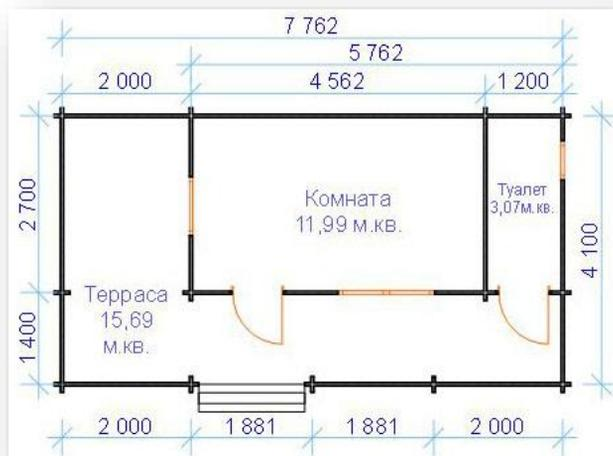
Обвязка, стеновой комплект профилированный брус 45x135 , фундамент блоки, крыша ондулин.
