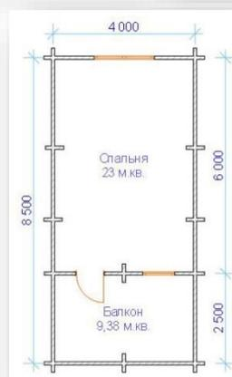
Обвязка 150x150, лаги 50x150, черный пол 25x150 пропитанная антипиреном, стропильная система профилированный брус напильный по проекту 90 x 135.
