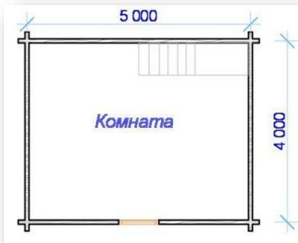
Обвязка 150x150, лаги 50x150, черный пол 25x150 пропитанная антипиреном, стропильная система профилированный брус напильный по проекту 90x135.
