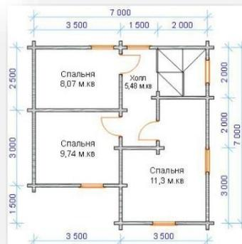
Обвязка 200x150, лаги 50x150, черный пол 25x150 пропитанная антипиреном, стропильная система профилированный брус напильный по проекту 140 x 135.
